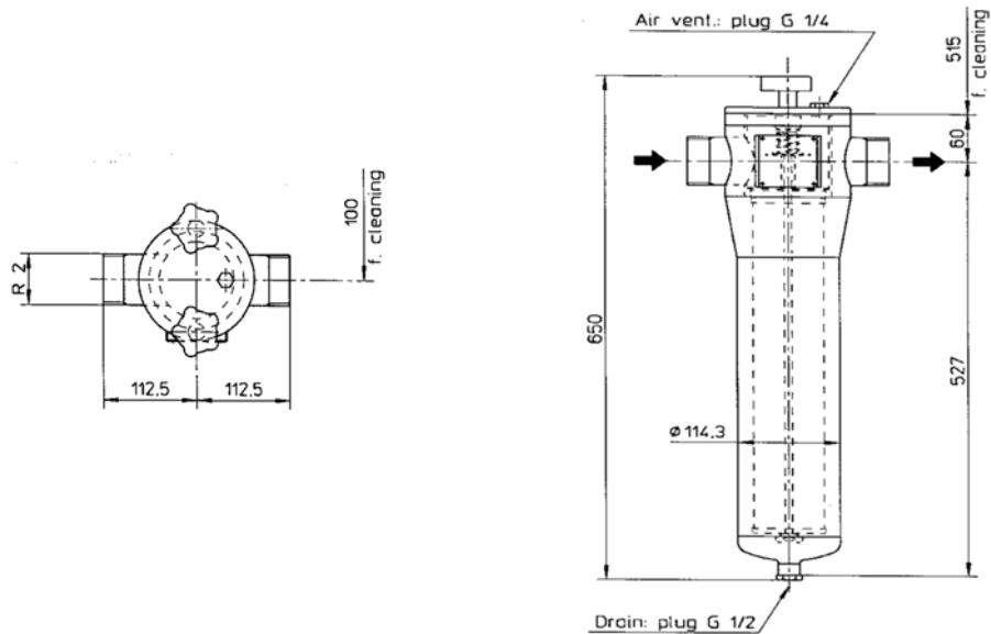
HiFlux Micro-line 1050 SS er fremstillet helt i rustfrit syrefast stål EN 1.4404 og opfylder gældende standarder og normer for trykbeholdere.
